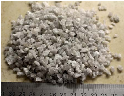
Weißer, gebrochener Edelkorund für feuerfeste Produkte und Schleifmittel
